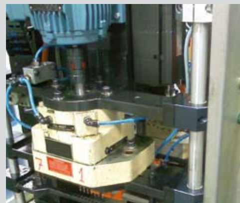
Spannende Bearbeitung mit DryLin® R-Lineargleitlagern vertikal und DryLin® W-Führungen horizontal in Bohremulsion. Machining with DryLin® R linear bearings vertical and DryLin® W guides horizontal in drilling emulsions.
