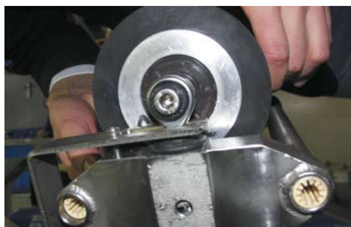
Kunststoffgleitlager in Dreh- und Schleifmaschinen für die Druckindustrie Polymer bearings in turning and grinding machines for printing industry
