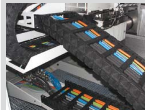
Vorkonfektionierte E-Kette® mit Chainflex®-Leitungen Pre-harnessed E-Chain® with Chainflex® cables
