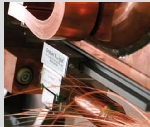
DryLin® T in Schweißzange. 24h Einsatz DryLin® T in welding guns. 24h operation
