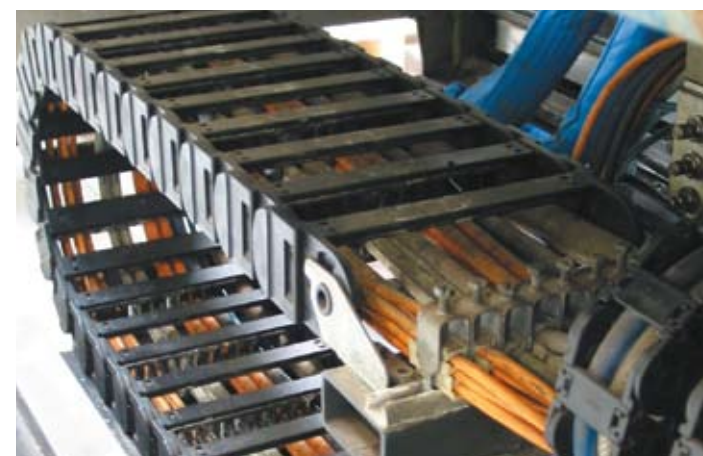
Topzustand auch nach 9 Jahren: E-Kette® in einer hoch präzisen Dreh- und Schleifmaschine Top condition even after nine years: E-Chain® in a high precision turning and grinding machine
