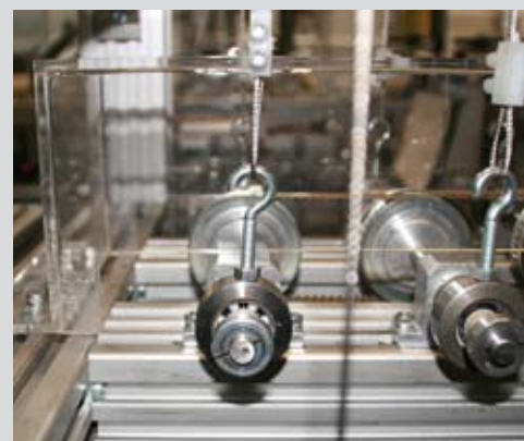
Kugellagertest im igus®-Gleitlager- labor Tests of ball bearings in igus® lab
