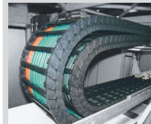
Übereinander liegende E6 für reduzierte Vibrationen und höchste Fräsgenauigkeit Nested E6 for minimized vibrations and best milling accuracy
