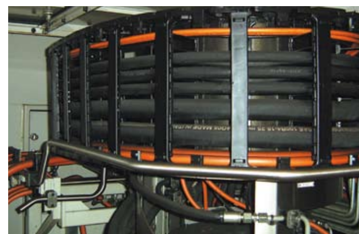
E-Kette® E6 in einer CNC-Schleifmaschine: Ihr sechsteiliger Aufbau und ihr geringes Gewicht erlauben besonders leichtgängige Bewegungen E-Chain® E6 in a CNC grinding machine: It six-piece design and minimum weight permit extremely smooth movements
