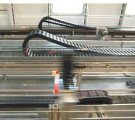
Zug-Schubkräfte Geschwindigkeit bis 10 m/s, Beschleunigungen bis 200 m/s² werden getestet Push Pull forces speed up to 10 m/s, acceleration up to 200 m/s² are tested
