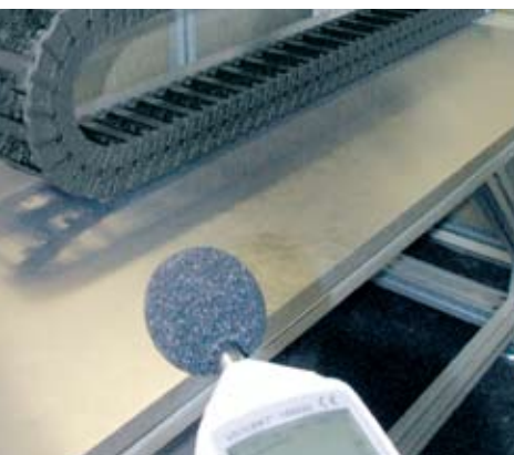
Geräuschprüfung in eigener Schallkammer Noise level test inside an igus® acoustic cell
