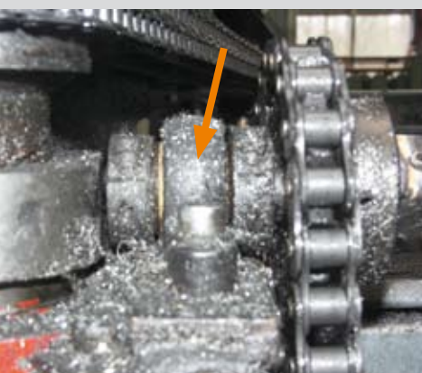
Metallspäne, Öl, Staub: Wartungs- freies igubal®-Stehlager in einer Verschachtelungsmaschine Swarfs, oil and dust: Maintenance-free igu- bal® pillow block bearing in a inter- lacing machine
